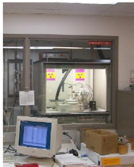
IUMSC Bruker Goniostat and 2Kx2K CCD detector
